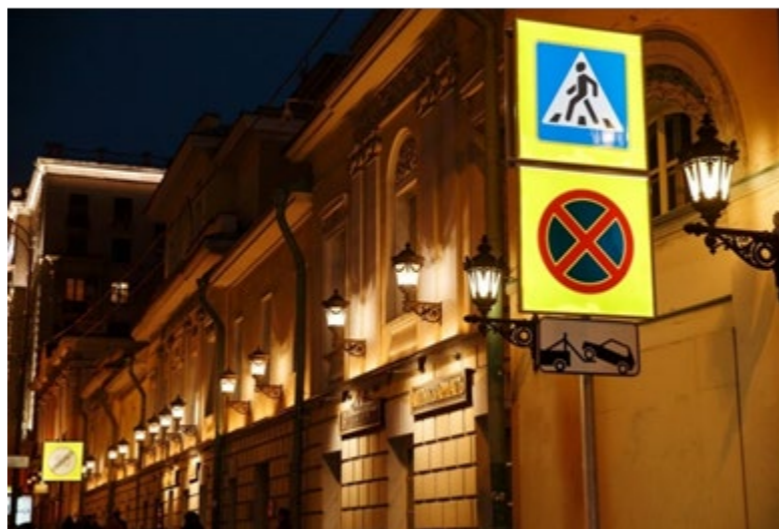
Рисунок 1.40 - Пример исполнения знаков дорожных с внутренним освещением
