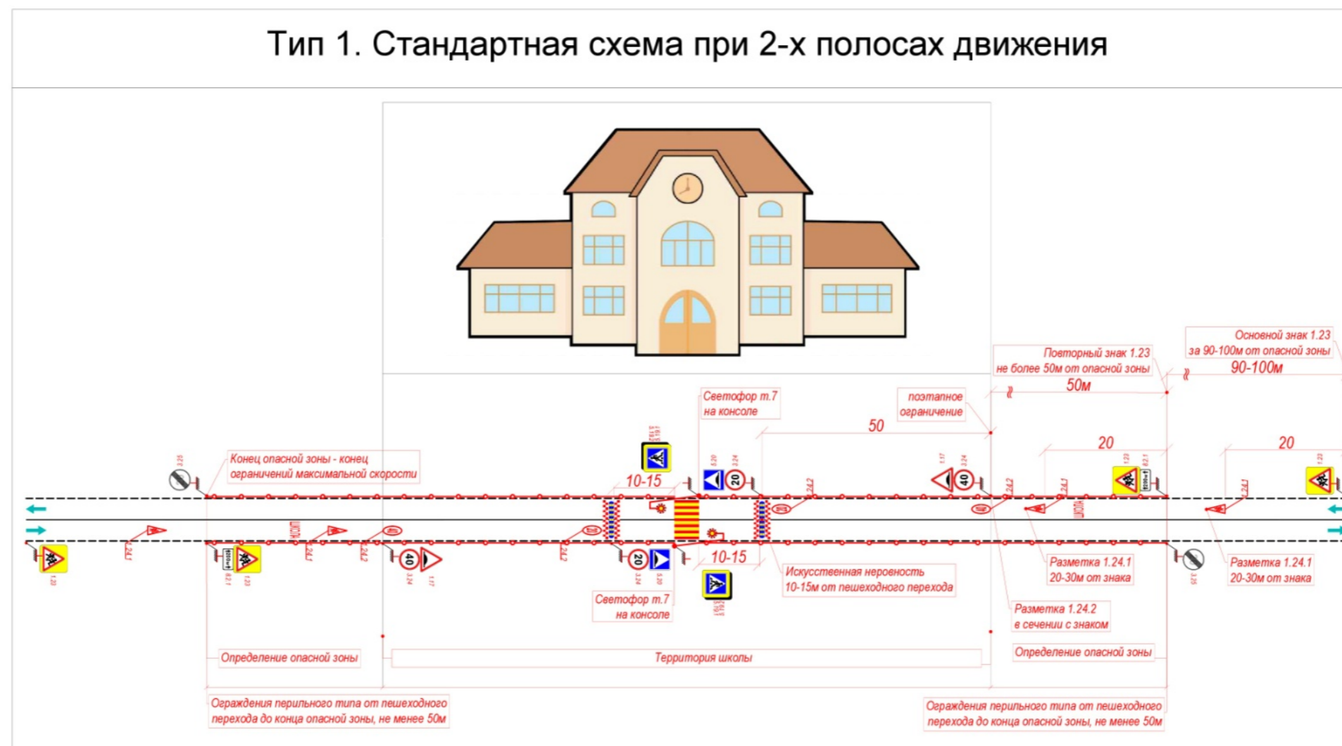
Схема 44 – Схема типового мероприятия по обеспечению БДД в районе детских учреждений при условиях «1+1» полосами для движения
