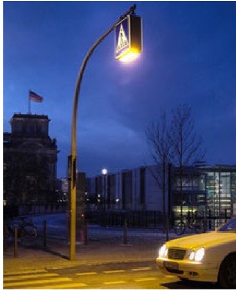
Рисунок 1.41 - Пример дорожных знаков 5.19.1, 5.19.2 с встроенными светодиодными светильниками уличного освещения
